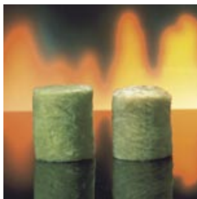
Слева образец каменной ваты до испытания на огнестойкость, справа – после проведения испытания.
