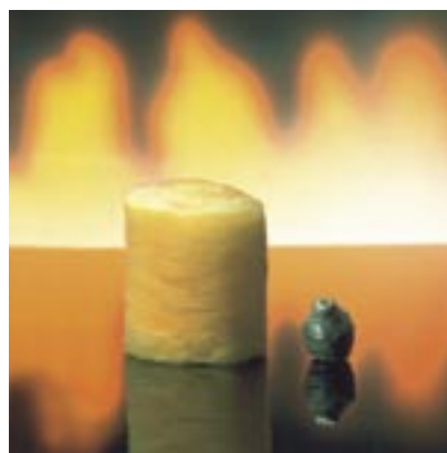
Слева образец из стекловаты до испытания на огнестойкость, справа – то, что осталось от образца после проведения испытания.
